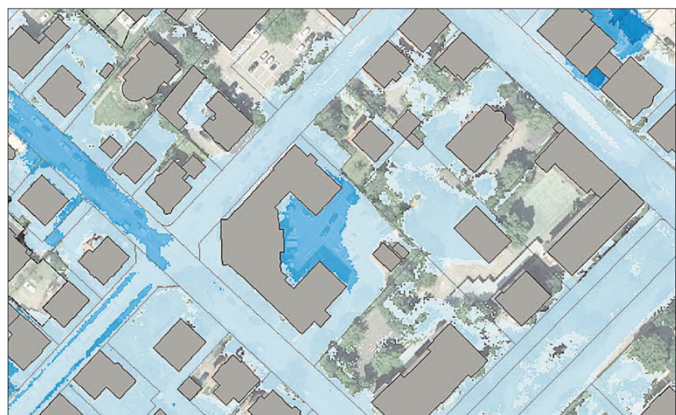
Der Gebäudegrundriss des Landratsamtes Reutlingen ist bei heftigen Niederschlägen ungünstig, weil sich die Fluten im Innenhof sammeln.
